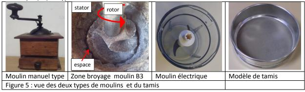
La différence entre les 3 moulins manuels s'est faite sur une différence d'écartement entre la partie rotor et stator du système de broyage mesurée de manière imparfaite par un jeu de cales. Il a été possible d'obtenir une valeur moyenne de l'espace entre rotor et stator, de 10-15  $\mu$ m pour les moulins B1 et B2 et 28  $\mu$ m pour le moulin B3.
