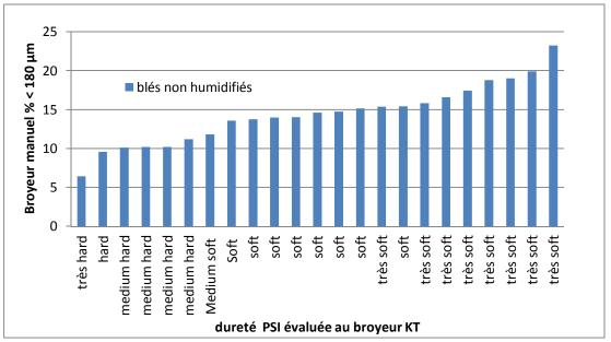
Figure 12 : Pourcentage d'extraction moyen au tamis de 180  $\mu$ m (mouture moulin manuel B3) en fonction de la dureté PSI
