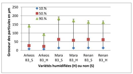
Figure 11 : Influence de l'humidification sur la grosseur des particules pour des proportions en volume de la farine, de 10 %, 50 % et 90 %
